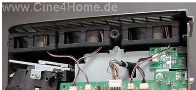
Durch die unmittelbare Nähe der Lüftung zur Lampe wurde eine Lichtfalle integriert,
