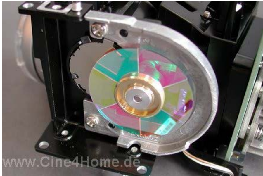
Das Farbrad ist direkt an den kompakten Lichtweg montiert
