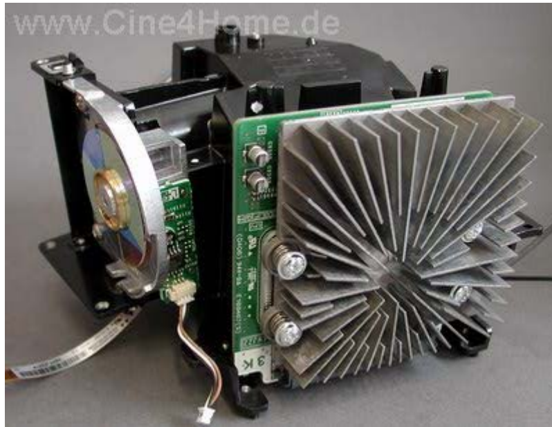
Der Kühlkörper auf der Rückseite des DMD-Chips Unten: Der Extra-Lüfter führt die Warmluft ab
