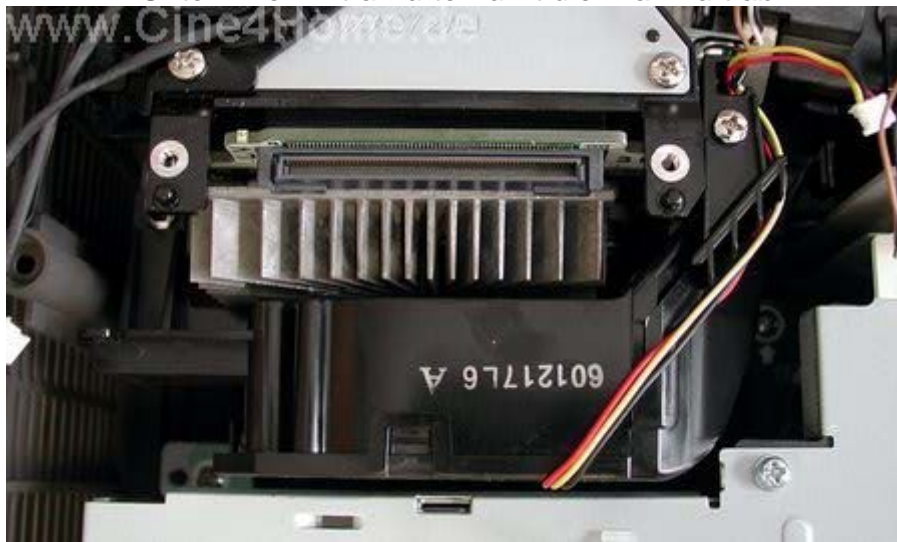
Der Kühlkörper auf der Rückseite des DMD-Chips Unten: Der Extra-Lüfter führt die Warmluft ab
