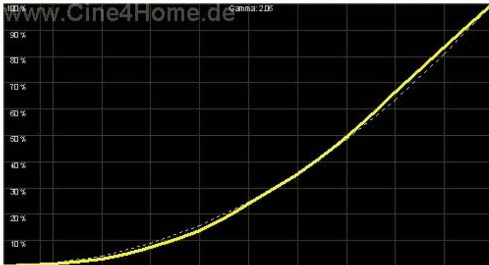
Gammaverlauf der BC0-Funktion
