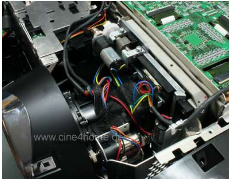
Die Optik wird von kleinen Motoren per Zahnräder angetrieben
