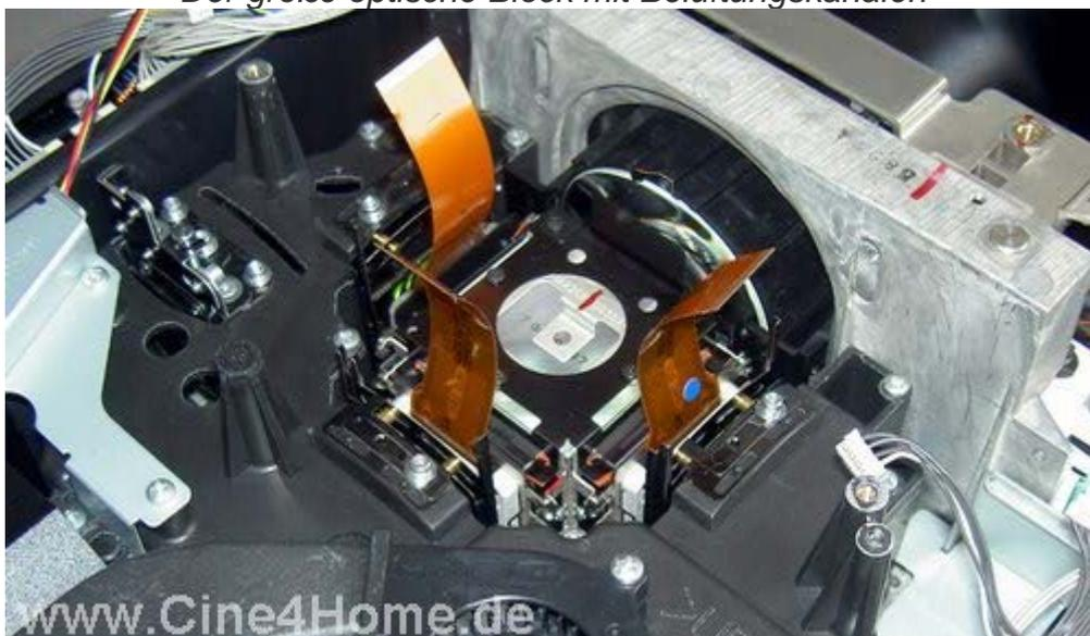
Besonders praktisch ist der solide und räumlich großzügige Aufbau für eventuelle Staubreinigungen, hier kommt man ohne große Mühen an alle gefährdete Bereiche heran. Insgesamt ist der gesamte technische Aufbau des PLV80 äußerst vorbildlich und so solide, wie man es von einem Profigerät erwartet. Hier wurde nicht an Schrauben gespart, sondern Belastungsfähigkeit geht vor Kostenersparnis. Ein Umstand, der sich natürlich in dem Preis des Projektors (rund. 4900.-) widerspiegelt.
