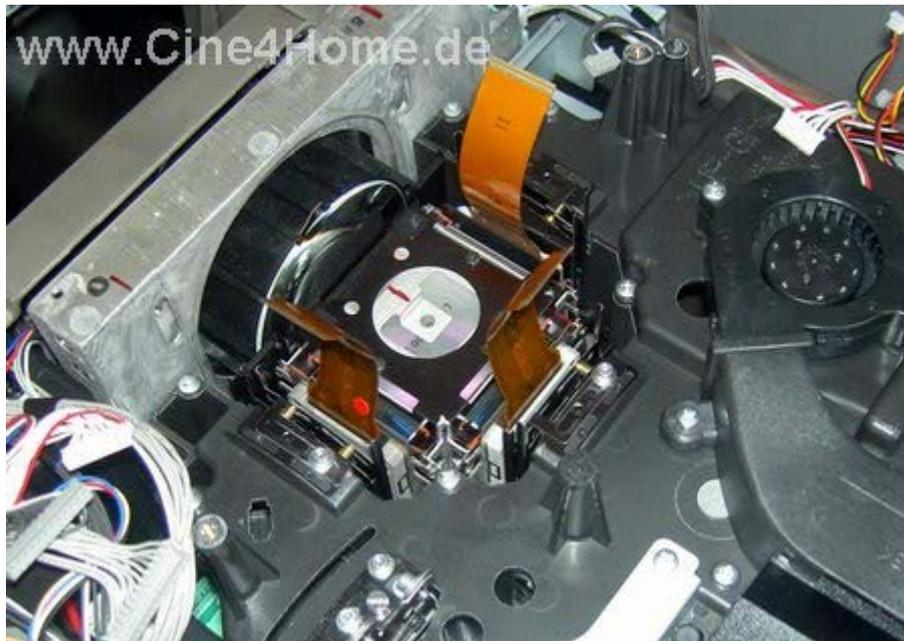
*Der große optische Block mit Belüftungskanälen*
