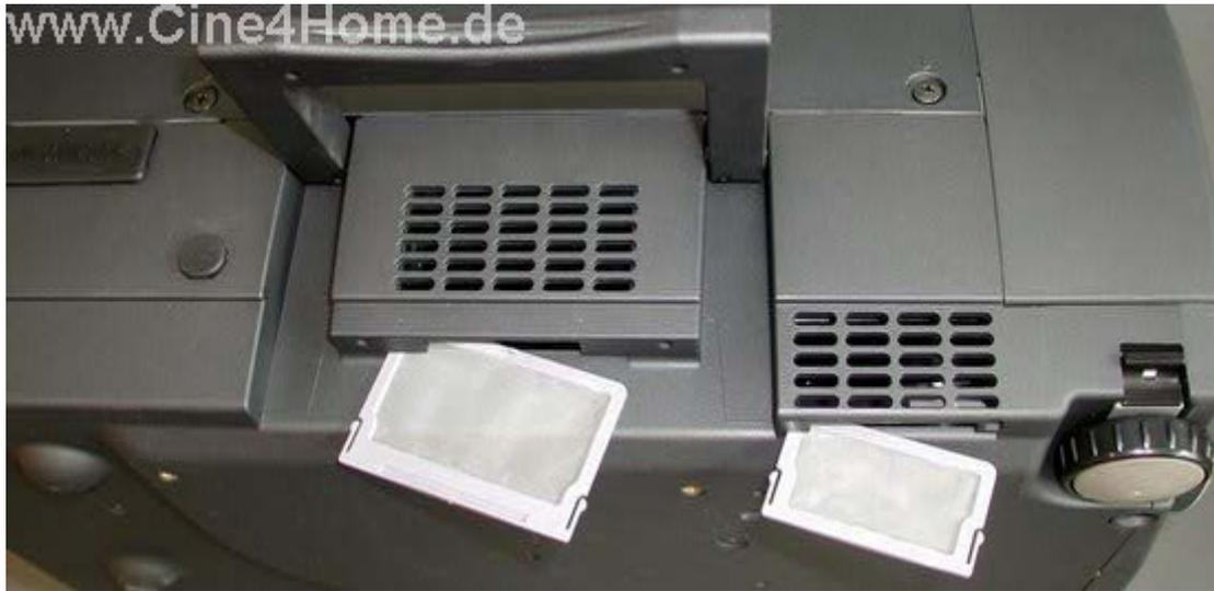
*Die Ansaugstutzen mit Feinfilter*
