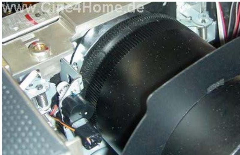
*Die hochwertige Optik-Mechanik mit Antriebsmotoren*
