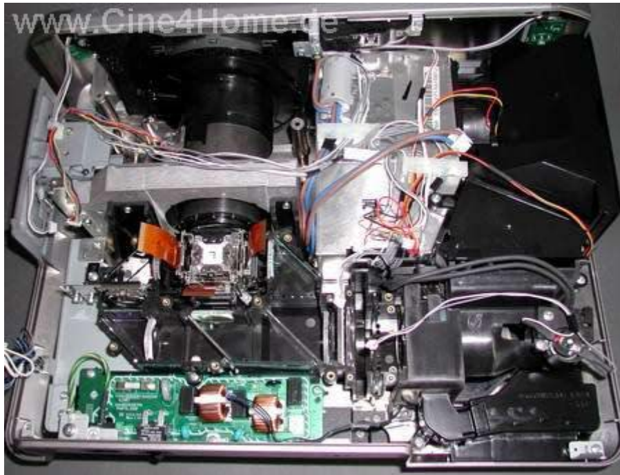
Projektor mit geöffnetem Lichtweg
