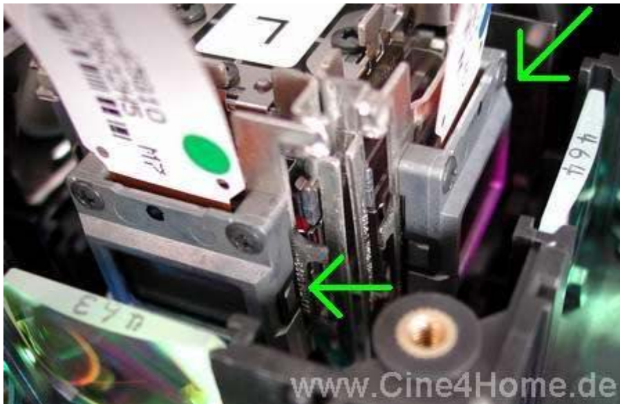
Die neuen D5 Panels in der Großaufnahme (Pfeile), montiert am Prismenblock
