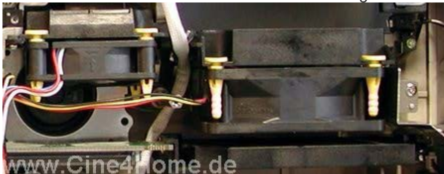
Alle Lüfter sind mit Gummistiften befestigt
