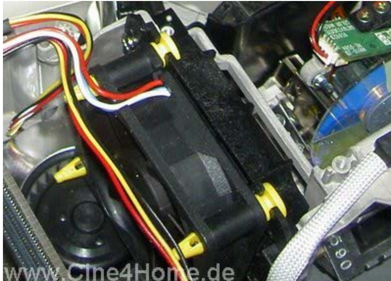
Alle Lüfter sind mit Gummistiften befestigt
