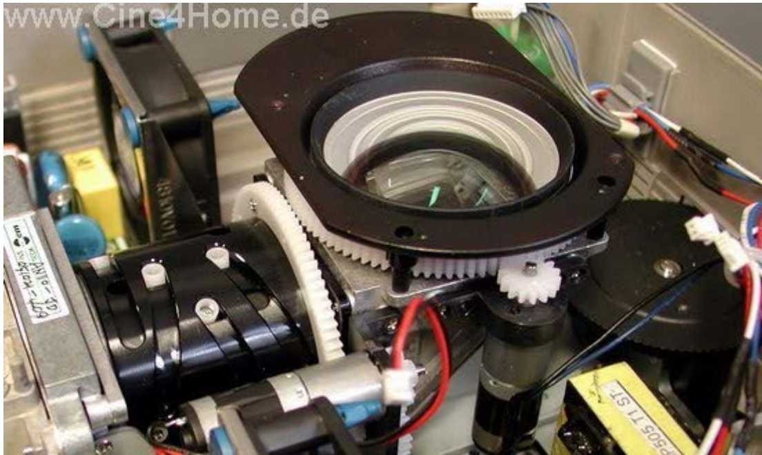
Zoom und Schärfe-Antrieb per Motoren
